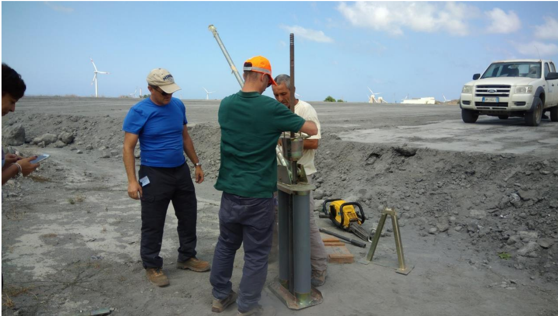
Fig. 2: Estrazione di un segmento di carota dal punto C. In basso a destra il carotatore a percussione
